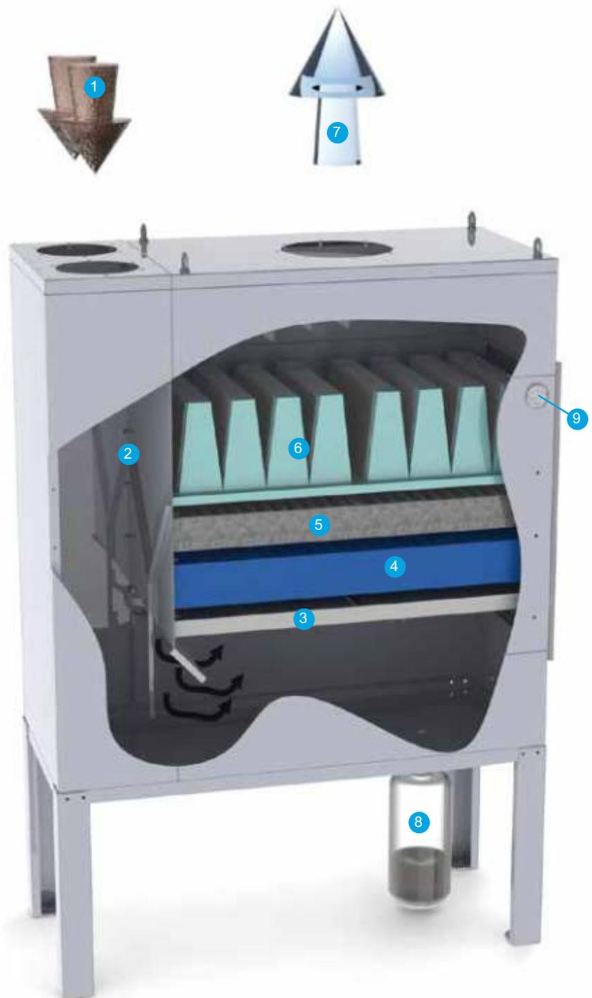
Der Filter Mist Compact wurde speziell für Zentralabsaugungen und große Absaugleistungen konzipiert. Dabei handelt es sich um einen statischen Filter für Öl- und Emulsionsnebel, der aus modular aufgebauten Filterkassetten besteht, die sich in einem pulverbeschichteten Stahlgehäuse befinden. Das Gehäuse besitzt eine große Wartungs- und Inspektionsklappe, um einen problemlosen Zugang zu sämtlichen Filterkomponenten und damit eine einfache Wartung zu gewährleisten.
